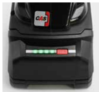
LED-Anzeige für Ladezustand am Akku
