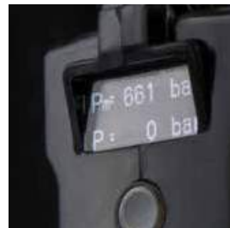
Multifunktionales OLED-Display mit Touch-Taste
