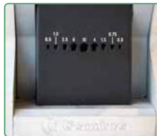
PNB-4KE Detailansicht des Crimpbereiches
